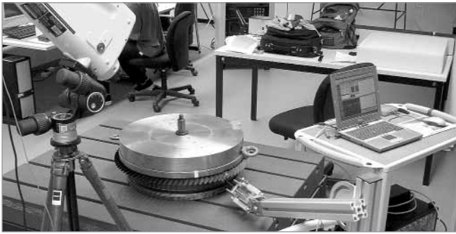
Abbildung 7: Experimentelle Ermittlung einer Mistuningverteilung
