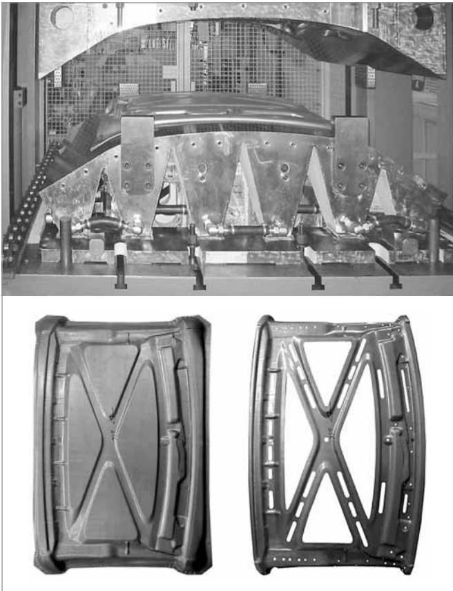
Abbildung 4: Umformwerkzeug (oben) und prototypisch umgeformtes und beschnittenes Klappdach-Innenteil (unten) (Quelle: DaimlerChrysler AG, Sindelfingen)
