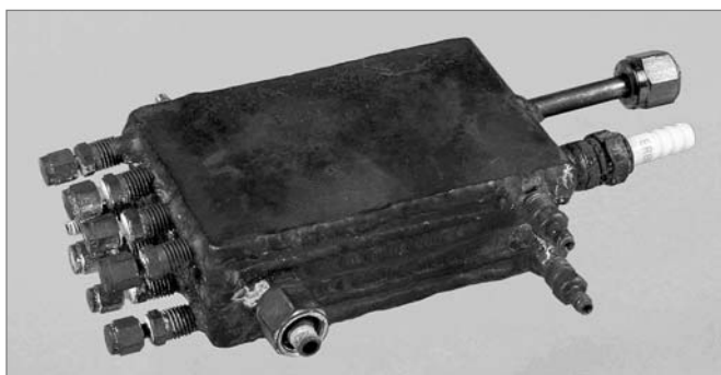
Abbildung 2: Reformer-Brenner-Einheit mit Zündkerze (98 x 62 x 32 mm)
