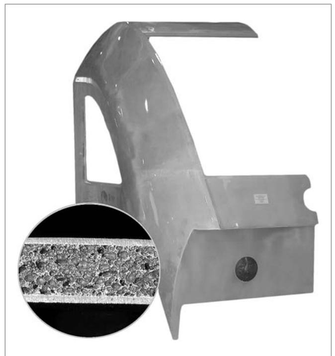
Abbildung 7: Demonstrator „Frontmodul“ in Originalgröße (Oberfläche gestrahlt und lackiert)
