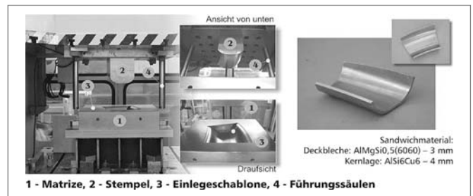
Abbildung 4: Umformwerkzeug und ein umgeformtes Probeteil aus dem Sandwichblech
